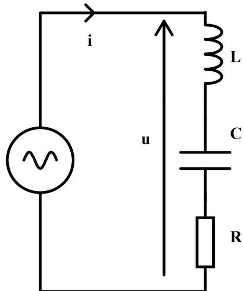
1. Le condensateur de capacité variable est en premier lieu réglé sur une valeur  $C_1$  permettant d'obtenir une valeur maximale de l'intensité efficace du courant.
